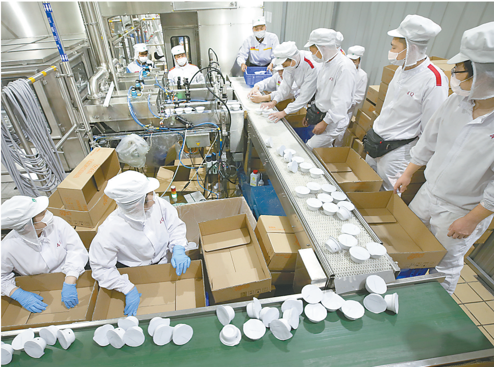
10月26日，蒙牛乳业（焦作）有限公司预制杯酸奶生产线顺利完成7批次70000杯保温试验。该生产线为蒙牛集团第一条预制杯酸奶生产线，采用世界上最先进的无菌灌装新技术，总投资2亿元，预计11月下旬投产。
