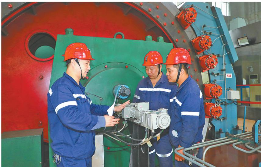
为确保四季度安全生产,焦煤集团赵国一矿围绕安全管理重点及薄弱环节,对重点部位、重要岗位、重大设备进行安全检查,以查促改,保障安全生产正常进行。图为10月15日该矿机队职工在主井绞车房排查设备隐患。 王代华 摄
