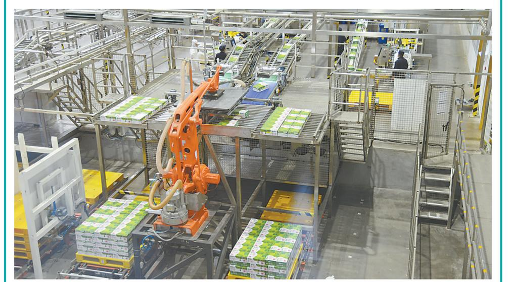
9月10日,蒙牛百亿集群·焦作5G智慧工厂内,码垛机械臂正在运转作业。蒙牛百亿集群·焦作5G智慧工厂现有生产线11条,主要生产灭菌乳、调制乳、乳饮料、发酵酸奶,所有设备都应用了云计算、大数据、5G等技术,在设计、制造、供应和服务环节实现了无缝协作,形成了全产业链工业生态体系。本报记者 翟鹏程 摄
