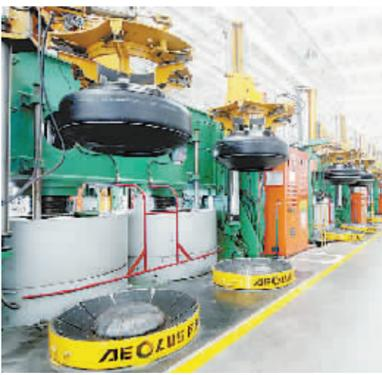
风神轮胎自动化程度极高的硫化生产线。 风 喧 摄
