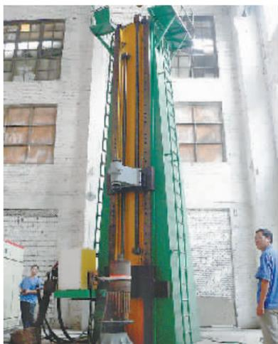
国内最大的多功能中频淬火机床日前由焦作神华重机公司自行研制并试验成功。该设备采用先进的IGBT中频电源,输出功率为800KW,不但可以对长度6000mm、直径1000mm的大型辊轴进行表面淬火,而且适用于直径6000mm以内大型齿轮、齿圈及回转支承的热处理加工,可广泛应用于煤矿、建材、冶金、风电等行业。杨金伦 摄
