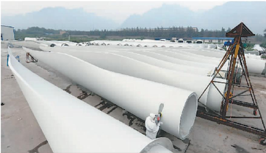
位于沁阳市沁北产业集聚区的河南名都风电有限公司,联合北京航空航天大学研发设计的兆瓦级风电叶片,采用玻璃纤维增强聚酯树脂,在保证质量的同时,较通常的环氧树脂材料减少有效成本三分之一,为该公司赢得了较大的客源市场和利润空间。图为该公司员工日前在加工生产1.5MW级风电叶片。本报记者 杨帆 摄
