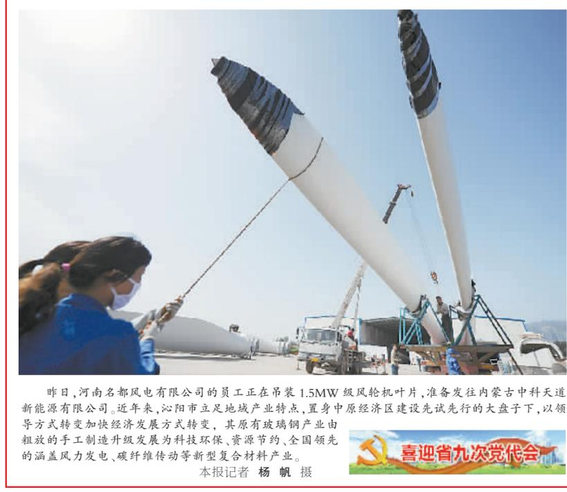
昨日,河南名都风电有限公司的职工正在吊装1.5MW级风轮机叶片,准备发往内蒙古中科天通新能源有限公司。近年来,沁阳市立足地域产业特点,置身中原经济区建设先试先行的大盘子下,以领导方式转变加快经济发展方式转变,其原有玻璃钢产业由粗放的手工制造升级为科技环保、资源节约、全国领先的涵盖风力发电、碳纤维传动等新型复合材料产业。本报记者 杨帆 摄
