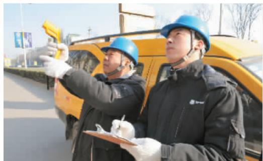
1月5日,市电业局组织人员利用红外测温仪,对城区10千伏线路进行全面检查,及时处理线路隐患,确保春节期间人民群众正常用电。图为工作人员正在对10千伏设备线#2台区进行测温。
