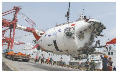
5月31日,“蛟龙号”载人潜水器被缓缓吊起,安装到“向阳红09”号科考船上。
