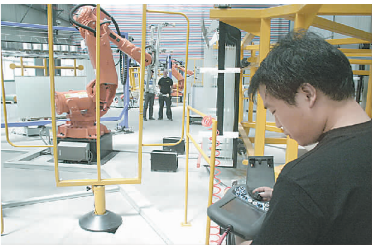
6月13日,博爱县裕华光伏新材料股份有限公司员工正在操作工业机器人进行作业。该公司镀膜生产线现用机械手为ABB IRB-6640工业机器人,是一款高产能且
