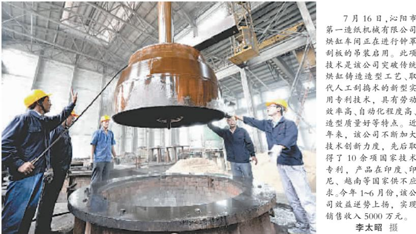
7月16日,沁阳市第一造纸机械有限公司烘缸车间正在进行烘缸刮板的吊装启用。此项技术是该公司突破传统烘缸铸造造型工艺,取用人工到捣模的新型实用专利技术,具有劳动效率高、自动化程度高、造型质量好等特点。近年来,该公司不断加大技术创新力度,先后取得了10余项国家技术专利,产品在印度、印尼、越南等国家供不应求。今年1-6月份,该公司效益逆势上扬,实现销售收入5000万元。李太昭 摄
