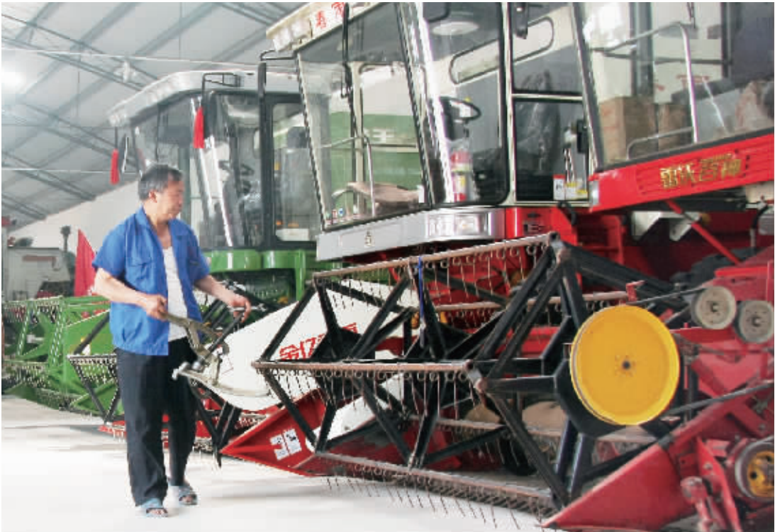
图为财旺农机合作社的机手正在检修小麦联合收割机。
