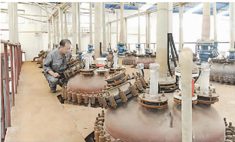
5月24日,沁阳市海世鸿工贸有限责任公司的工人正在车间检查氯化石蜡反应程度。该公司位于沁阳市产业集聚区沁北园区,凭借就近使用吴华宇航提供液氧的优势,于去年10月份建成二期项目,达到了年产8万吨的设计产能,预计今年销售额将突破2亿元。
