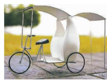
乍看这辆三轮车似乎没什么特别的,夏日里除了那大大的遮阳篷能暂时躲避暑外,好像没别的用处。其实你错了,那大大的遮阳篷是用太阳能电池板组成的,烈日下能快速将太阳能存储起来。别急,它不光是为了收集太阳能,车后部的箱体其实是部制冷机,这才是它的神奇之处。利用收集的太阳能,在炎热的夏日当中,它能在为你遮挡烈日的同时,还可以为你制作清凉可口的冰淇淋。
