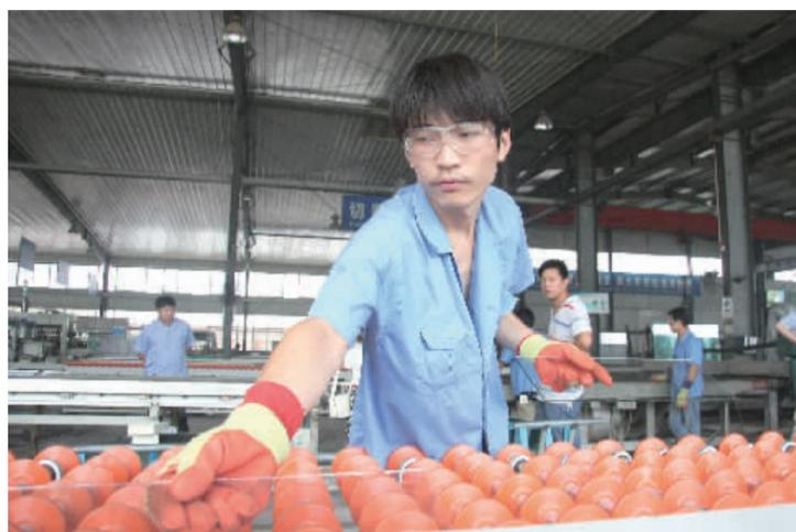
7月8日,焦作飞鸿安全玻璃有限公司员工将钢化玻璃放到打磨流水线上。该公司位于县产业集聚区,主要生产各种家电玻璃制品,年生产产值达1000万平方米。本报记者 王芳 摄
