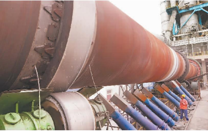
昨日,沁阳市金隅水泥有限公司回转窑前一名工人正在巡检。该公司综合利用吴华宇航沁阳氯碱基地离子膜烧碱、聚氯乙烯树脂项目产生的废料电石渣,年可生产熟料77.5万吨、水泥100万吨,年消化电石渣113万吨,与常规石灰石水泥生产线相比,每年少排放二氧化碳50余万吨。 本报记者 刘金元 摄
