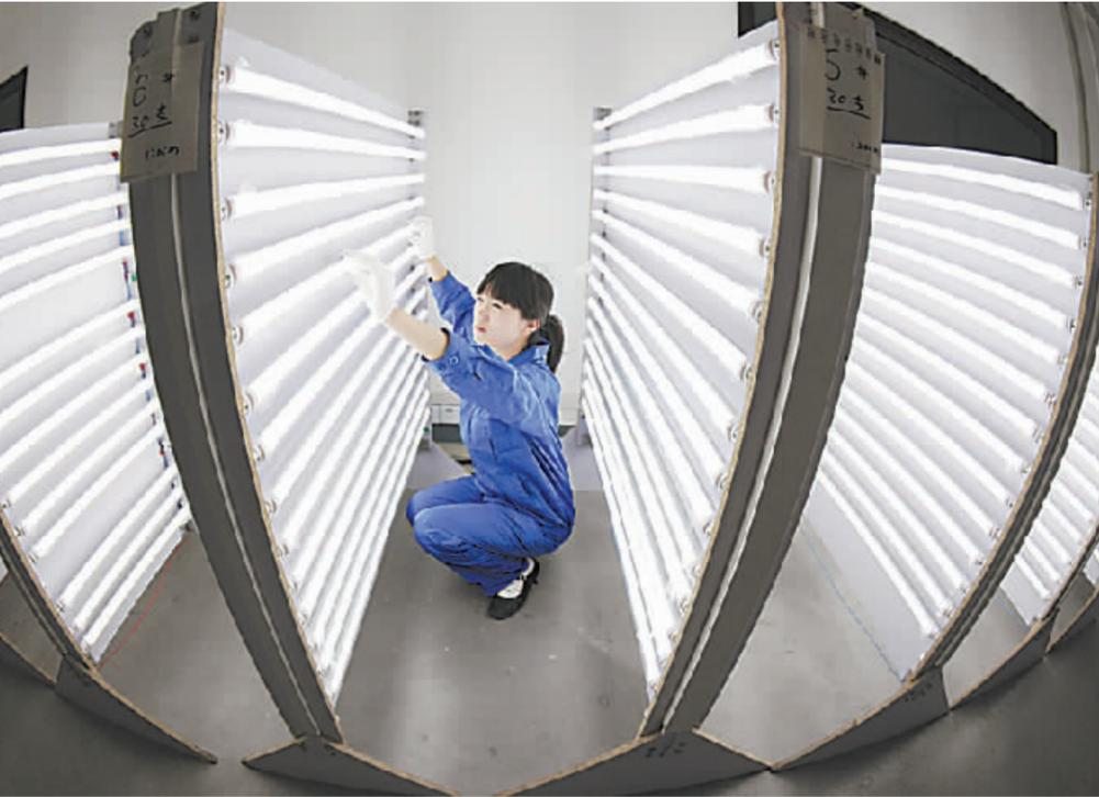
图为多氟多化工股份有限公司光电分公司员工正在对节能灯管进行检测。
