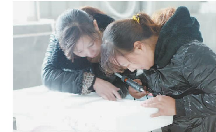
11月1日,天虽渐寒,但在位于马村区安阳城街道的焦作市煜鹏机械制造有限公司车间内,却是一派热火朝天的工作景象。该公司以生产汽车铸件等产品为主,助力该区经济发展。图为该公司车间工人正在打磨泡沫磨具。崔晶 秦莉莉 摄
