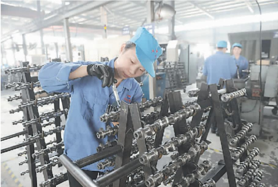
昨日,河南中汇汽车零部件有限公司的质量检验员在检测凸轴质量。位于博爱县产业集聚区的河南中汇公司是我国中部地区唯一的轿车发动机凸轴生产企业。近年来,该公司依靠技术创新,不断开发新产品,使销售收入大幅增长,产品残次率始终控制在万分之二以下。今年上半年,该公司主导产品轿车发动机凸轴的市场占有率与去年同期相比上升了20%。本报记者 杨帆 摄
