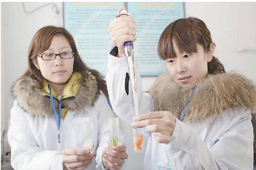
近日,解放区农产品质量安全检测站检测人员正在对蔬菜进行检测。春节临近,为让市民吃上放心菜、安全菜,解放区农产品质量安全检测站重点对辖区农贸市场和大型超市销售的蔬菜、水果进行农药残留检测,每天抽检5次,每次抽检样品约20个,严防不合格农产品流入市场。
