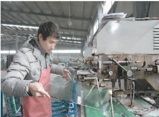
焦作市巡返特种玻璃厂生产车间内,员工正在用自动玻璃钻孔机对汽车玻璃进行打孔作业。
