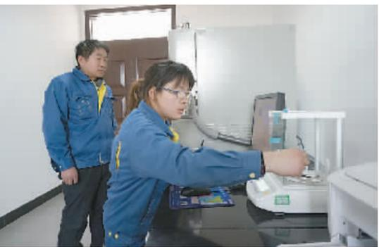
中原内配研发中心气体检测室内,技术人员正在对铸铁中碳硫进行分析。
