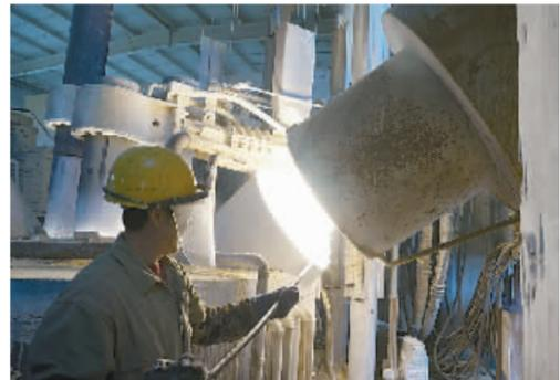
在该公司电熔炉车间内,工人正在清理排渣烟道。
