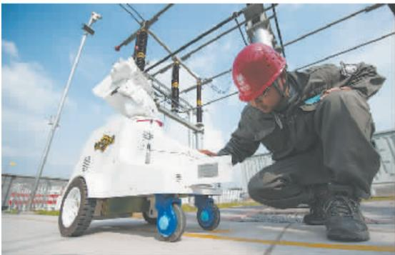
4月3日,在国家电网重庆电力公司220千伏大石智能变电站内,重庆市首台变电站智能巡检机器人正式投入运行,机器人拥有红外线热像仪和可见光摄像机,代替人工对该变电站进行昼夜全天候的设备巡视。图为国网重庆市电力公司检修分公司北碚运维站站长杨剑飞在检查巡检机器人。(新华社发)
