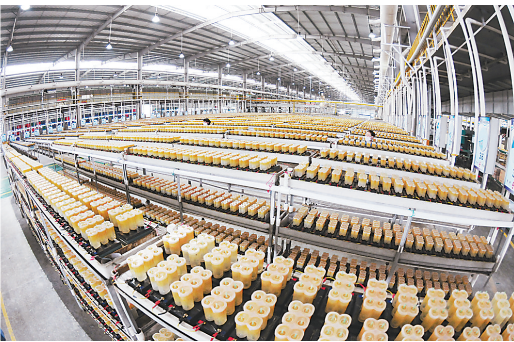
昨日，河南超威电源有限公司成品车间的工人正在为电池注酸。长期以来，该公司注重科技创新，提高工艺技术水平，对产品生产过程中加注硫酸环节进行改进性试验，改用机械定量加注，减少酸性物质挥发，节省了人力成本，增强加酸精确度，每年可回收2800多吨硫酸进行循环利用，年节约资金80多万元。
