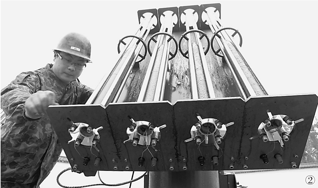
图① 气象工作者在发射火箭弹，实施人工增雨作业。图② 气象工作者在人工增雨作业前检查发射装置。
