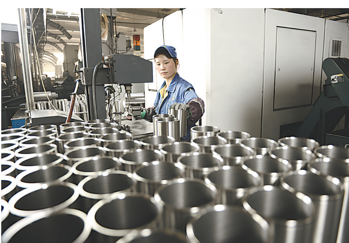
汽车发动机气缸套加工数字化车间是河南省中原内配股份有限公司基于当前行业装备水平的实际以及信息化、智能化发展趋势而实施的重大智能制造专项，具备自动上下料、生产过程实时监控、自动在线监测、设备故障自动预警等功能，大量运用工业机器人、机械手、柔性制造生产系统和在线自动检测装置，使产品的制造精度和生产过程质量稳定性得到显著提升，可满足国际高端主机市场的个性化需求。图为近日该公司员工在检测机器人自动系统生产的乘用车气缸套。
