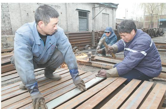
2014年12月16日，河南能源焦煤公司鑫珠春公司技改人员正在加工木质道板。去年以来，该公司积极开展创新创造、修旧利废活动，从开发利用废旧物资入手，对原有废旧的11号工钢技改加工成铁质道板替换下木质道板，回收复用达到了100%。截至目前，该公司共加工使用木质道板1800余块，节约生产成本11万余元。
