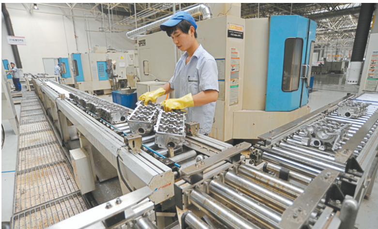
瑞庆汽车发动机技术有限公司缸盖生产线员工正在工作。 本报记者 王正义 摄
