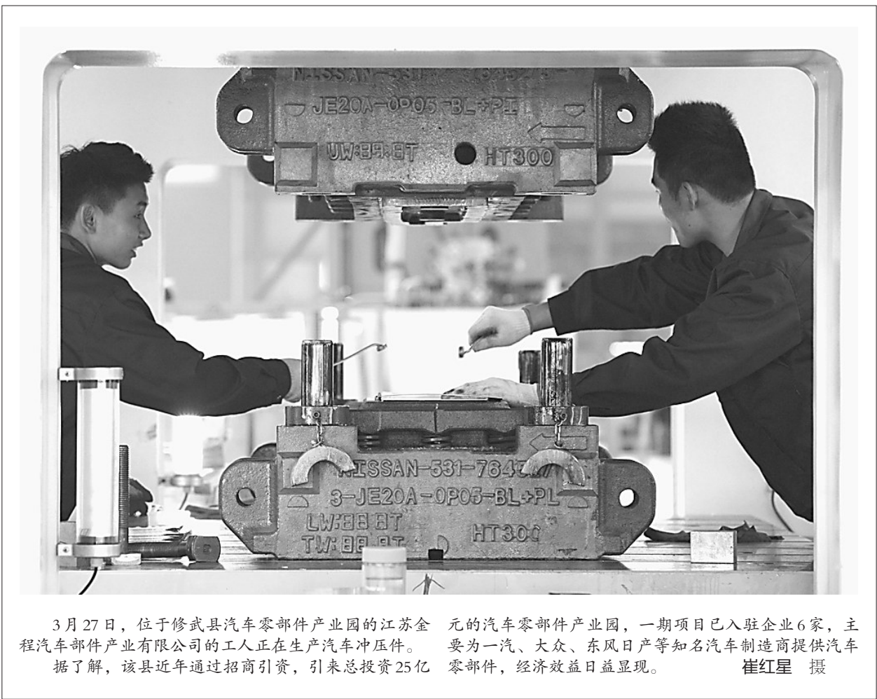
3月27日，位于修武县汽车零部件产业园的江苏金元汽车零部件产业的工人正在生产汽车冲压件。据了解，该县近年通过招商引资，引来总投资25亿元的汽车零部件产业园，一期项目已入驻企业6家，主要为一汽、大众、东风日产等知名汽车制造商提供汽车零部件，经济效益日益显现。 崔红星 摄
