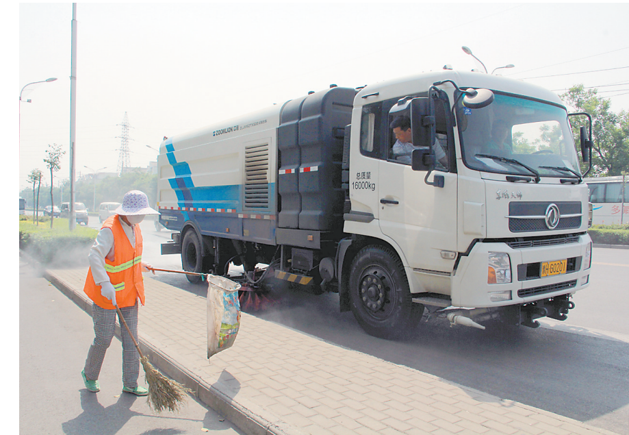
5月25日，中站区环卫处机械化清扫车正在解放西路清扫作业。近日，中站区环卫处投资80余万元新购进机械化清扫车1辆。该车主要具有路面清扫、路面洗刷、高压清洗、垃圾收集、污水回收、喷雾等作业功能，可有效减轻环卫工人的劳动强度。
