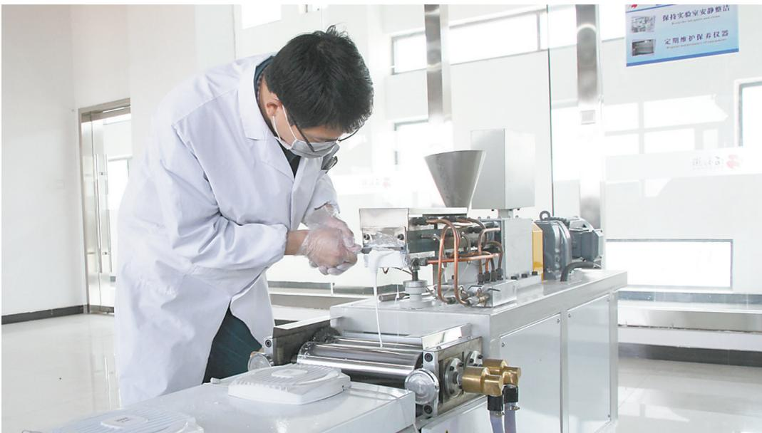
据悉，进入2015年以来，钛白粉在粉涂方面的行业发展呈扩大上扬之势。为开发粉涂版块，佰利联氯化钛白粉公司抽调科研骨干潜心研究，有效地解决了客户反馈的钛白粉粉缩孔较多及不耐高温黄变的问题。该粉涂设备主要应用于涂料型钛白粉性能研发，将不同称量、不同规格的钛白粉试样、树脂等预混合原材料经加热、磨碎、挤压等多道生产工序，加工具有不同特性的涂料成品。通过不同参数的对比，从而减小工艺差异、改进产品性能，提升钛白粉研发能力，较好地满足了合作方个性化的市场需求。
