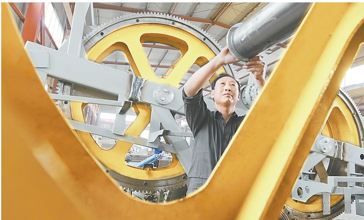
昨日,河南兰兴电力机械有限公司的工人正在安装张紧轮,该公司位于温县产业集聚区,近年来狠抓产品质量,
