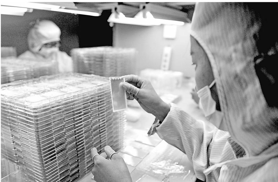
5月23日,位于沁阳市产业集聚区的沁阳睿为视讯技术有限公司的工人在生产LED背光源。该公司主要研发、生产各类LED背光源和3D微型显示器...
