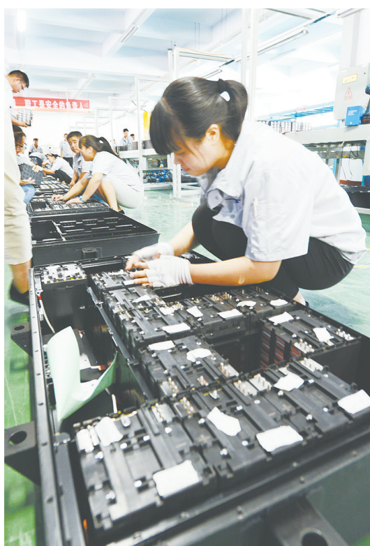
技术人员在组装电池。
