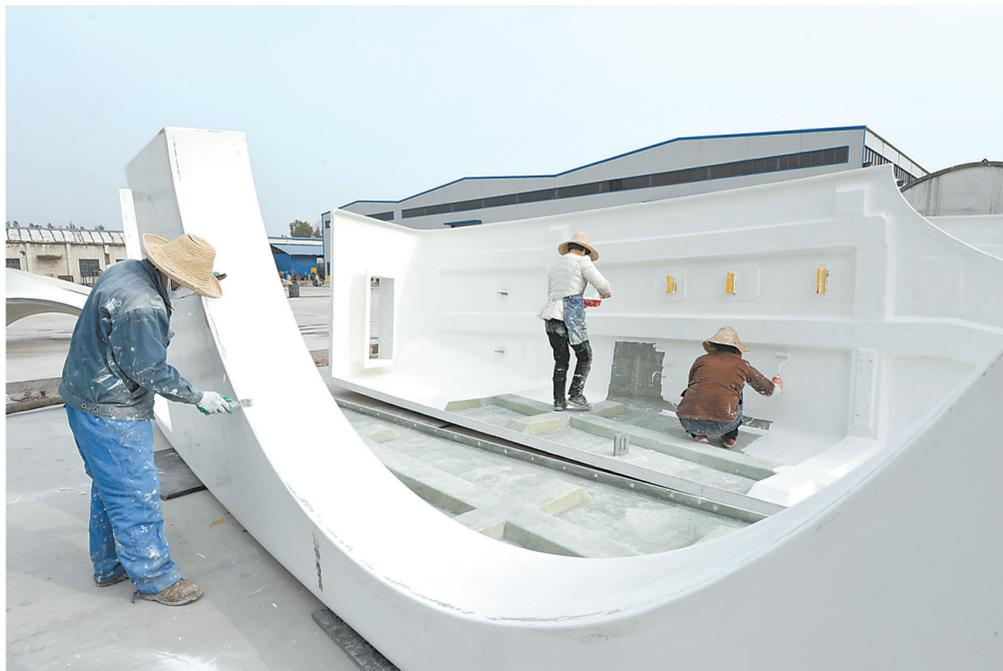
日前，沁阳市锦辉风电科技有限公司员工在加工生产1.5兆瓦级风电机组罩壳。近年来，该公司加大科技研发和人才引进力度，与多家知名风电企业签订配套生产玻璃钢罩壳合同，已成为目前全国最大的风力发电罩壳生产企业。
