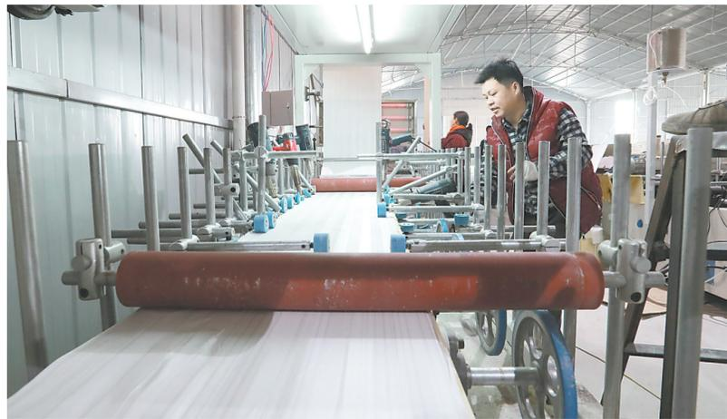
12月10日,在焦作市富泉塑业有限公司新上线的竹木纤维墙板车间,工人在抓紧生产竹木纤维墙板。此项目生产工艺以竹、木为基本原料,采用最新技术,通过挤压、覆膜和UV喷涂等工艺加工后制成板材,属于新型室内环保节能装饰材料。目前,该公司产销两旺,形势喜人。
